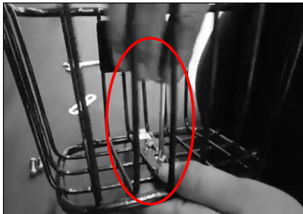
14. Colocar el soporte inferior del canasto y ajustar los tornillos con un destornillador phillips.
