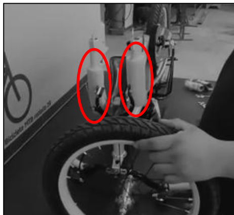
6. Quitar las protecciones de los caños para poder posicionar la rueda delantera.
