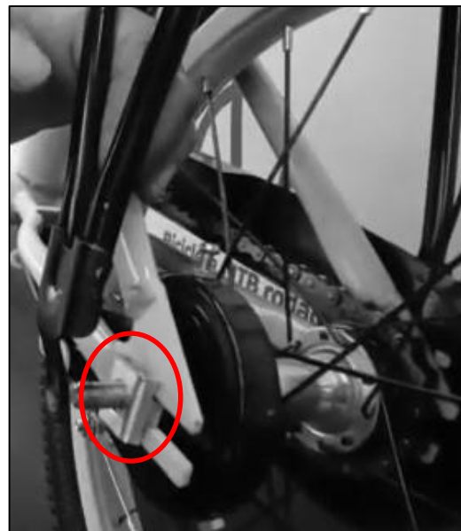
11. Ruedas estabilizadoras: Colocar el inserto de alineación (1) en posición. Asegúrese de que la pestaña de inserto de alineación (5) esté en la parte trasera del eje y en la ranura (6) de el marco.
