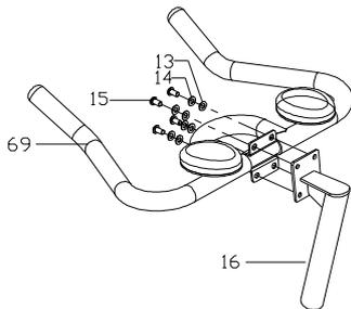
Paso 6: Conecte el poste del manubrio (16) al manubrio (69). Ajuste suavemente con 4 juegos de tornillos (15), Arandela elástica (14) y arandelas (13).
