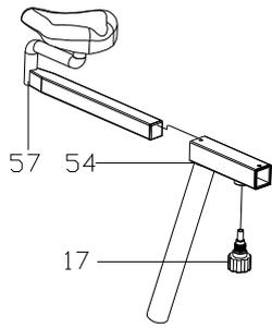
Paso 4: Deslice el caño horizontal para el asiento (57) dentro del caño fijo para el asiento (54), escoja la posición deseada y ajústela suavemente utilizando la perilla elástica (17)
