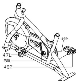
Paso 2: Instale el pedal izquierdo (47L) y el pedal derecho (48R) a la palanca izquierda (50L) y a la palanca derecha (49R) respectivamente.
