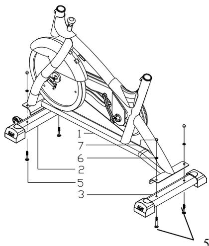
Paso 1: Utilizando los Bulones de Base (5), Arandelas (6) y tuercas (7), coloque la junta del caño delantero (2) y la junta del caño trasero (3) al cuerpo principal (1).
