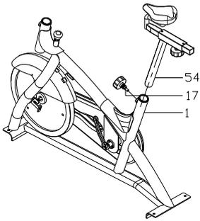
Paso 5: inserte el caño armado del asiento (54 + 57) al cuerpo principal (1), Seleccione la altura deseada, y ajústela suavemente utilizando la perilla elástica (17).
