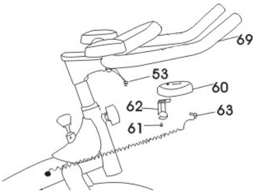
Paso 9: Ajuste el soporte de la consola (62) al manubrio (69) con tornillos adecuados (61). Coloque la consola (60) al soporte para la consola (62). Luego inserte el conector del cable de la consola (63) a la parte trasera de la consola (60).
