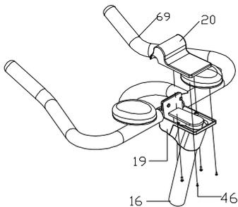
Paso 7: Coloque el protector alto del manubrio (20) y el bajo (19) sobre la junta entre manubrio (69) y el poste del manubrio (16), luego ajuste ambos protectores (20 y 19) con tornillos adecuados (46).
