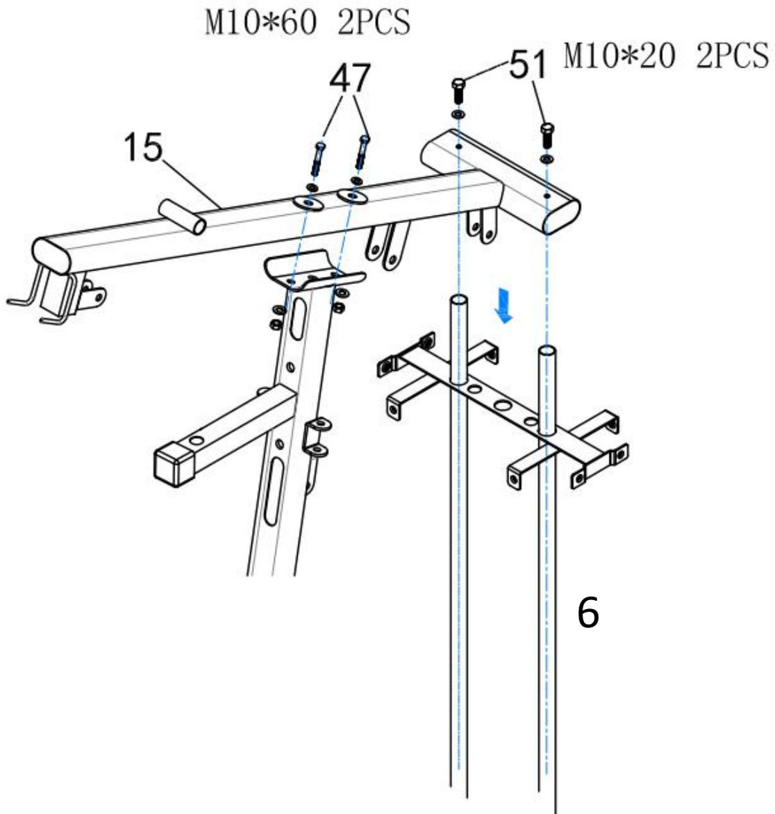
1. Fije el soporte superior (15) al soporte vertical (5) use el tornillo, la arandela y la tuerca (47) e insértelo en las barras metálicas usando el tornillo y la arandela (51)
