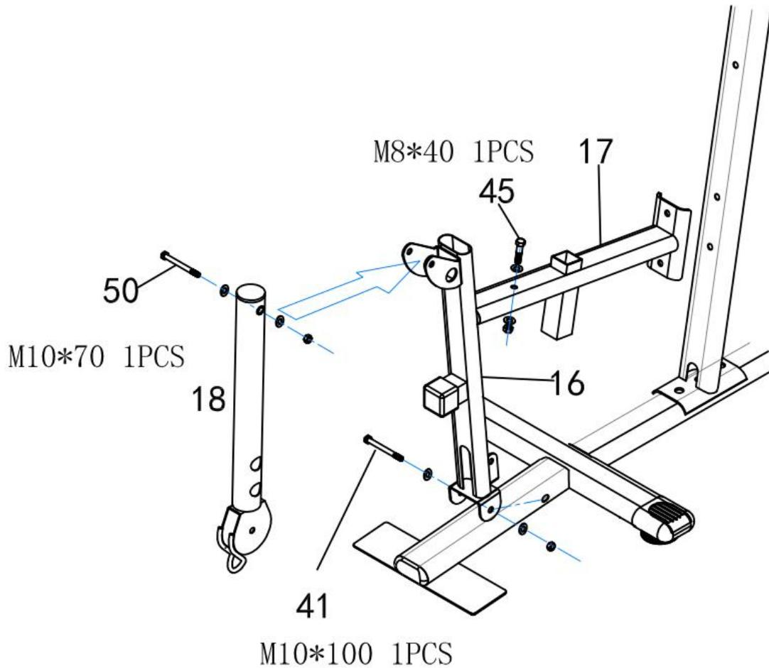
1. Fije el soporte del asiento delantero (16) a la base principal usando el tornillo y la arandela (41), luego coloque el soporte del asiento (17) en el soporte delantero (16) use tornillo, arandela y tuerca (45)
