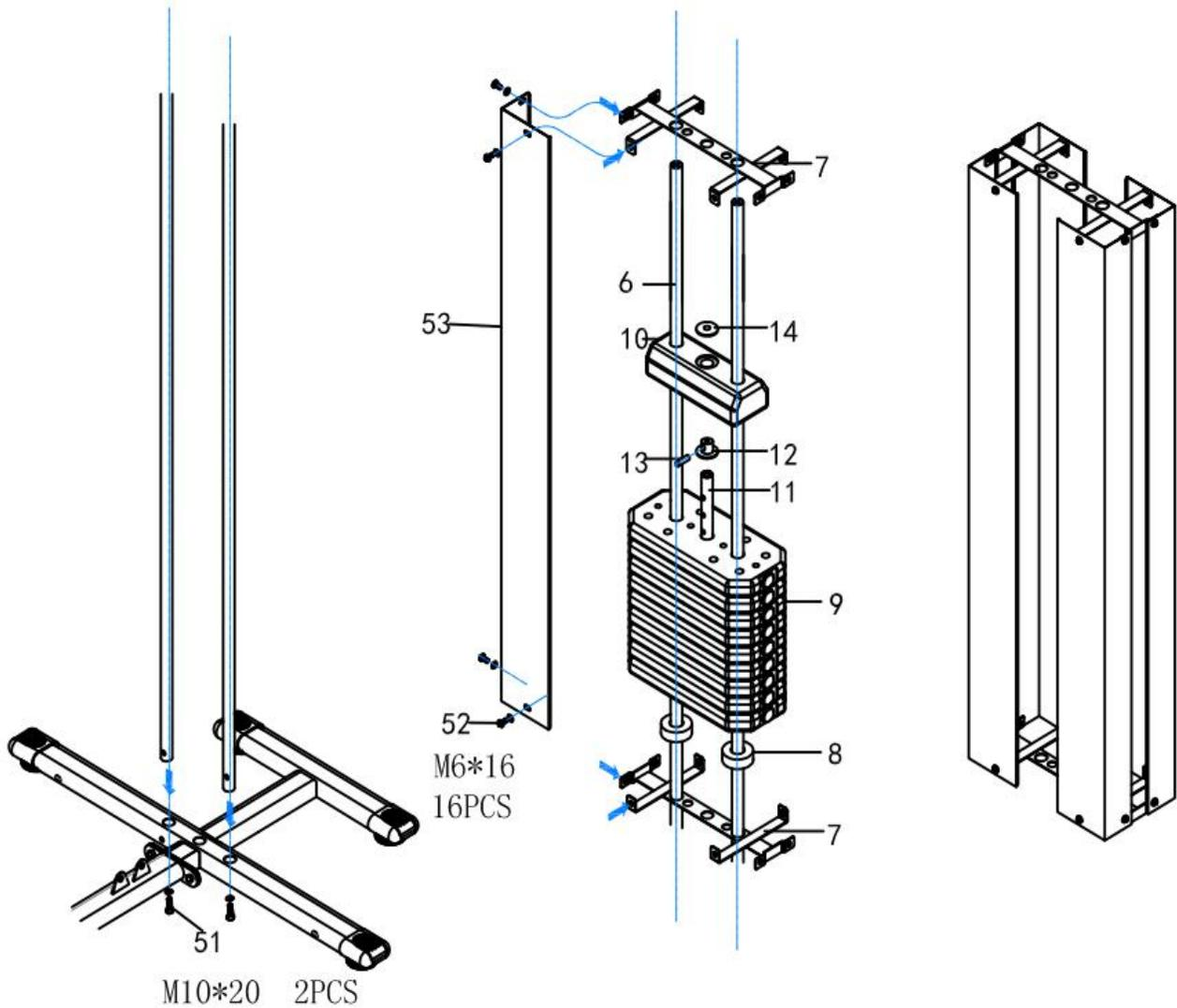
1. Inserte las barras metálicas (6) en el tornillo de la base principal (51)
