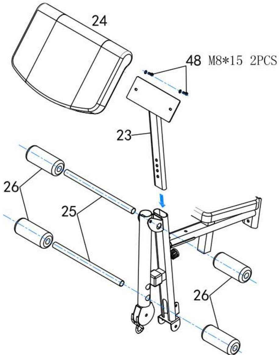
1. Conecte el cojín (24) al soporte metálico (23) use el tornillo y la arandela (48), luego insértelo en el soporte del asiento delantero y use la perilla (19)
