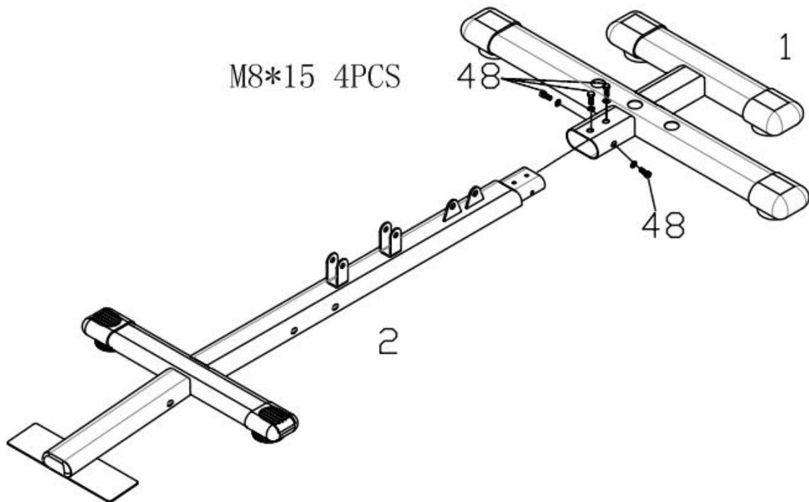
1. Conecte la base del estabilizador trasero (1) a la base principal (2) con tornillo, arandela y tuerca (48)
