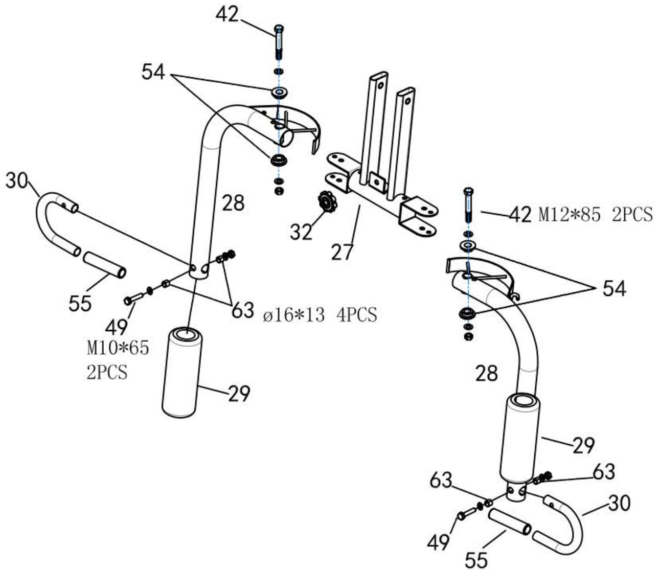
1. Coloque el brazo (28) en la prensa de pecho (27) use tornillos, arandelas y tuercas (42)
