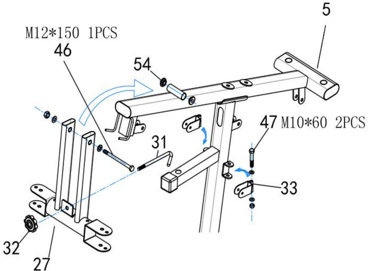
1. Inserte el casquillo (54) en el soporte superior, luego coloque la prensa de pecho (27) use Tornillo, arandela y tuerca (46)
