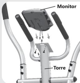
Primero quite los Tornillos que están fijados en el Monitor, almacenarlos serán utilizados posteriormente. Conecte los cables del monitor. Ponga los cables extra en la torre y afije el monitor a la torre con los Tornillos removido previamente, apriete firmemente.
