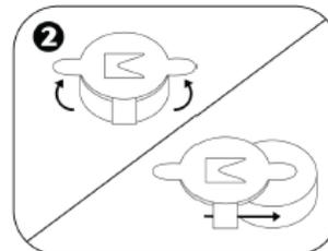
En el reverso de la pantalla, retire la tapa de la batería y deslícela hacia afuera.
