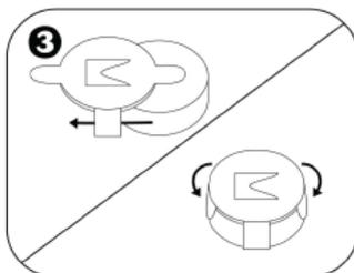
Inserte una nueva batería de 1,5V AG13, deslícela y luego cierre la tapa
