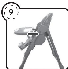
Como se muestra en la figura 7, tire del botón bajo la bandeja y colocar completamente, como se ve en la figura 8. Tire los botones de los dos lados debajo de la bandeja, alinee la ranura de la bandeja con las fijaciones de la misma, deslicela hasta escuchar el "click" y que no sea posible moverla. Como se muestra en la figura 9, según las necesidades del niño, tire del botón debajo de la bandeja y ajuste a la posición requerida.
