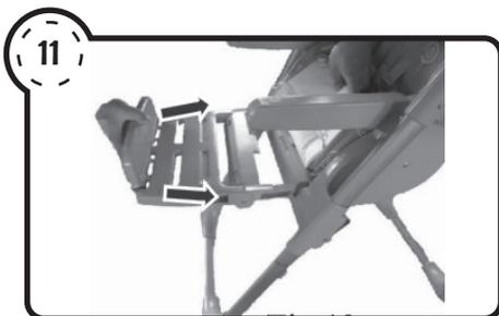
Como se muestra en la figura 10, en primer lugar alinear la hebilla del pedal a la ranura en la articulación de flexión del pedal. En la figura 11, alinear la hebilla en ambos lados del pedal en el leg de la silla e insertar hasta no poder moverla.
