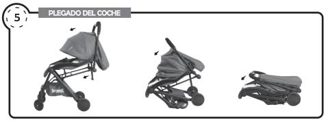
Para plegar el Coche Leggero, presione el botón de plegado y a la vez, deslice la traba de seguridad hacia la derecha. Empuje del manillar hacia adelante, verá que la estructura comenzará a plegarse fácilmente. Una vez plegado como muestra la tercer imagen, asegúrese de presionarlo para que la traba de plegado quede correctamente activada, asegurándose que el coche no volverá a abrirse.
