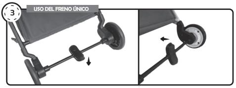
Coloque el freno de las ruedas traseras pisando el dispositivo que se encuentra en la estructura trasera del Coche Leggero. Por el contrario, para liberar las ruedas, levante el dispositivo hacia arriba.
