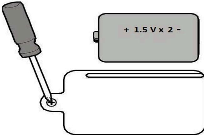
1. Aflojé el tornillo en la puerta del compartimiento de la batería con un destornillador Phillips.
