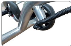
**Ajusté y apreté las tuercas y tornillos de la dirección en la parte trasera**
