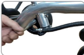
**Instalé el tornillo del extremo trasero**
