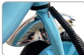
El extremo delantero del cable de dirección pasa de arriba a abajo
