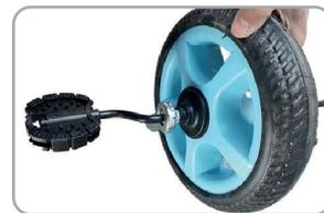
Instalá el soporte de la horquilla delantera y el pedal
