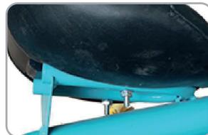
Instalá la silla del triciclo y fijala con sus respectivos tornillos
