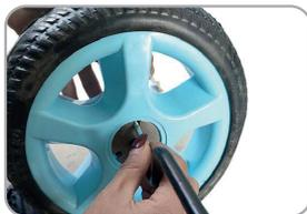
Instalá el espaciador del eje delantero
