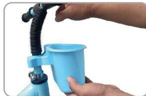
Instalá la cesta delantera, insertá el manillar en el tubo de la horquilla delantera y apretá el bloqueo en U
