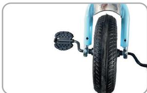
Instalá la rueda delantera en la horquilla delantera.
