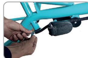
El cable de dirección se fija en el extremo inferior de la manija de descarga
