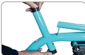
Instalá las almohadillas antideslizantes superior e inferior del tubo del mango de empuje.
