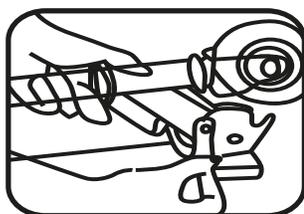
Para extender la barra de dirección, desenrosque la palanca para soltar el eje. Levante la barra de dirección en posición vertical, atornille la palanca para bloquear el eje.
