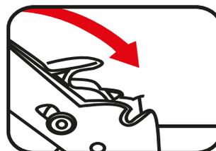
Para plegar el monopatín, desenrosque la palanca al eje. Baje la barra de dirección en posición horizontal, atornille la palanca para bloquear el eje.
