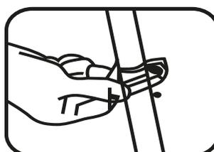
Ajuste la barra de dirección a la altura adecuada, bloquee el pestillo para asegurarlo firmemente.
