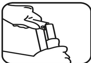
Inserte la empuñadura del mango. Presione el botón de resorte para encajar correctamente.
