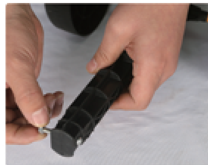
8. Desenroscar la parte superior del eje central del volante y dejar los tornillos.
