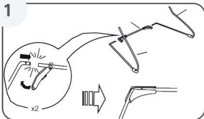
Colocó el tubo base sobre una superficie plana. Ubicó los cables de la base izquierda y derecha como se muestra. Colocó el cable de la base izquierda y el cable de la base derecha en el tubo base.
