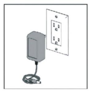
Conecte el cargador en el tomacorriente. La luz roja del cargador indicará que la carga de batería está en proceso, y la luz verde indicará que la batería ya se encuentra completamente cargada.
