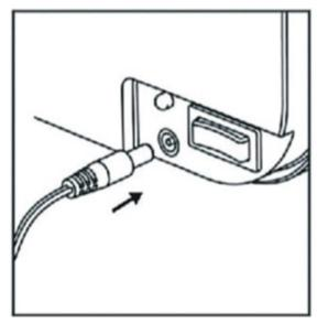
Asegúrese de que el interruptor esté en la posición de Apagado (OFF) antes de conectar el cargador. Conecte el cargador en el puerto que se ubica en el lado derecho de la caja de la batería.
