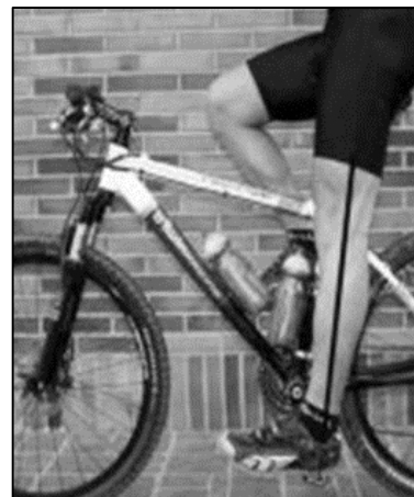
Posición en la que debe quedar la pierna con la altura del asiento correctamente ajustada.
