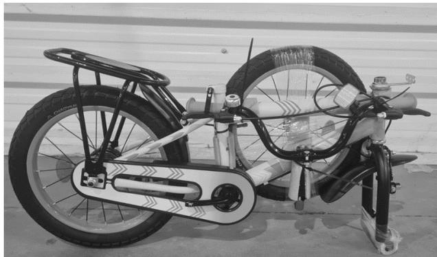
2. Notará que las partes que debe ensamblar son el Stem-manubrio, la rueda delantera, los pedales, las ruedas estabilizadoras y el canasto (en caso de que el modelo que usted tiene lo posea). Desempaquetar estas partes.
