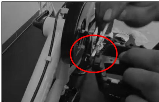
9. Los pedales vienen empaquetados con las leyendas “IZQUIERDO” y “DERECHO”. Coloque los pedales asegurándose de que el lado sea el correcto, considerando izquierdo (L) y derecho (R) cuando se encuentre montando la bicicleta. Luego realice el ajuste con una llave de boca de 13 mm (ajustando en sentido horario el pedal derecho y en sentido antihorario el pedal izquierdo ).
