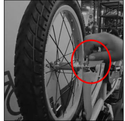
7. Colocar la rueda delantera y ajustar (ambos lados) con una llave de boca de 13 mm, haciendo girar la llave en sentido horario (posicionándose en frente de la llave).
