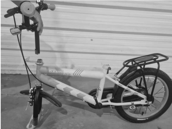
3. Insertar el Stem en la horquilla tomando la precaución de no estrangular y/o enredar los cables de freno.
