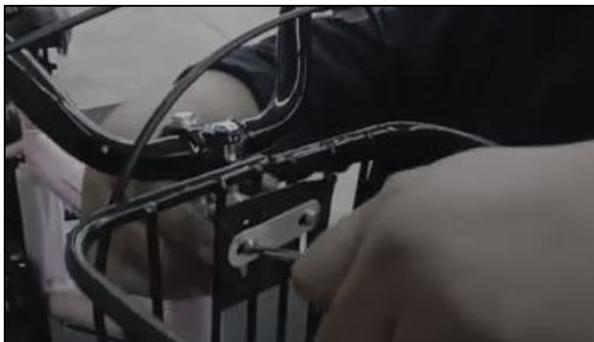
12. Colocar los tornillos de la parte superior del canasto y ajustarlos con un destornillador phillips
