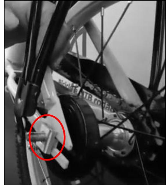
11. Ruedas estabilizadoras: Colocar el inserto de alineación (1) en posición. Asegúrese de que la pestaña de inserto de alineación (5) esté en la parte trasera del eje y en la ranura (6) de el marco.
