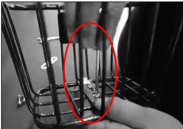
10. Colocar el soporte inferior del canasto y ajustar los tornillos con un destornillador phillips.
